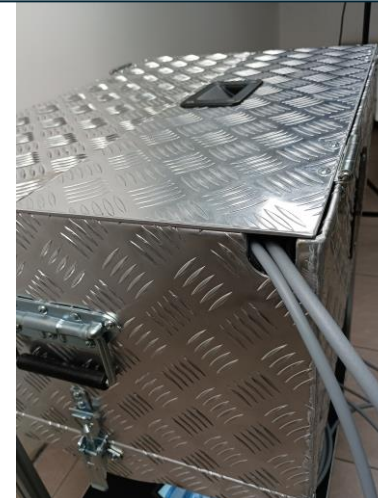
Aperture per passaggio cavi
