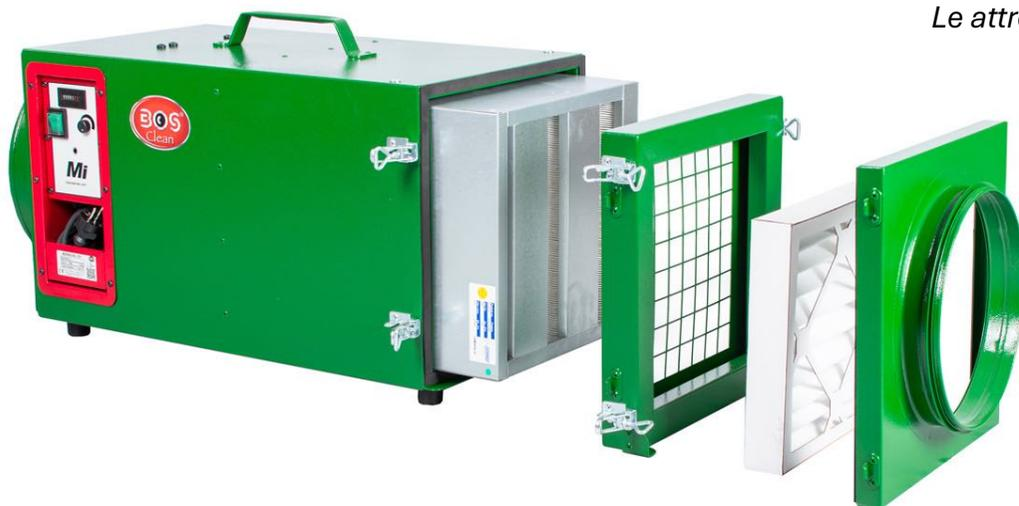
Per assicurare un processo di bonifica efficace, è fondamentale avere un punto di raccolta (ESTRATTORE) in grado di mantenere una pressione negativa adeguata all'interno del condotto da pulire durante tutte le operazioni di pulizia meccanica. Questo è cruciale per garantire una «cattura» efficace di tutte le polveri che si spostano dalla condotta verso il filtro di raccolta
