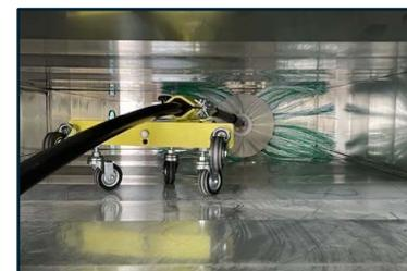
Peso macchina 42 kg dimensioni mm 600 x 750 x 945 H - peso cavo 21kg - totale 63Kg.
