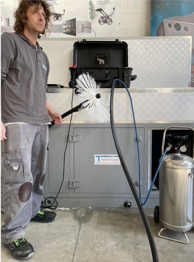
La pulizia delle condotte estrazione delle cucine richiede l'uso di diverse tecniche, inclusa la pulizia manuale con raschietti, la pulizia meccanica utilizzando spazzole aggressive e l'impiego di prodotti chimici schiumogeni.
